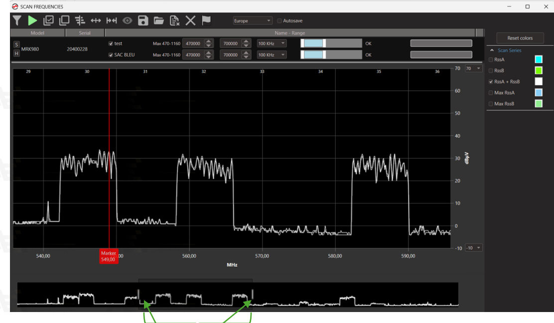
Vous pouvez activer les deux curseurs, l'un à gauche et l'autre à droite, pour zoomer ou dézoomer la plage de fréquences sélectionnée
