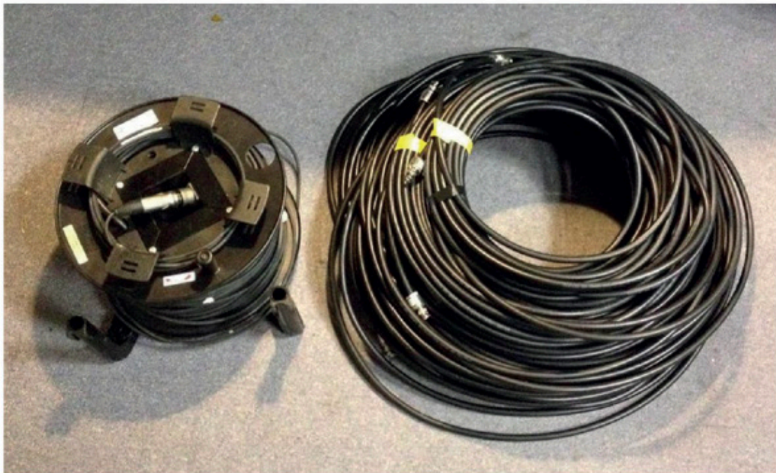
A gauche 150m de fibre optique, à droite 150m de câble RG213
