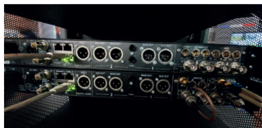
Option fibre optique en face arrière du MRK 980
