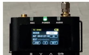
Cette fonction est particulièrement utile pour les réalisateurs devant travailler avec plusieurs caméras ou appareils. Elle garantit la synchronisation parfaite de vos fichiers audio et vidéo, ce qui rend le montage beaucoup plus fluide. Le DBTX peut aussi être synchronisé via la prise jack 3,5mm si vous utilisez des générateurs de timecode d'autres marques.
