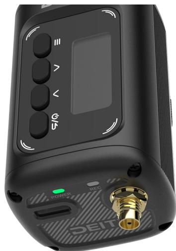
Sur cette même face inférieure se trouvent également le port d'antenne SMA 50 Ohms et le port USB-C. Cette configuration permet au DXTX de s'intégrer dans des systèmes plus complexes, comme un transmetteur IFB ou un émetteur pour liaison caméra, tout en enregistrant simultanément en local – servant ainsi de prise de sécurité permanente.
